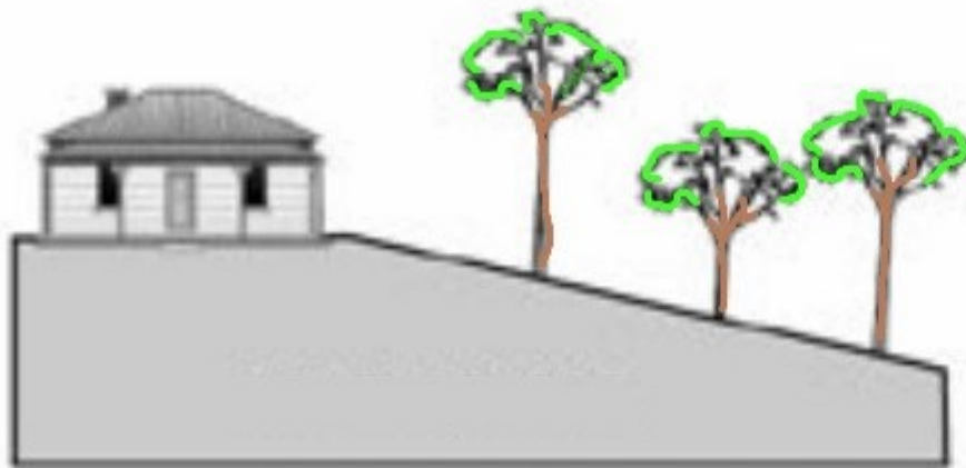
Pendenza ridotta -> ampiezza zona di intervento inferiore
